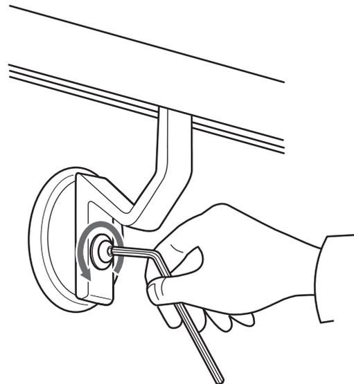
2. すべてのブラケットのボルトを取り外すと、手すりは取り外せます。(壁には丸座が残ります)
