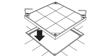
対角線上の固定ボルトを専用ハンドルに引っ掛けて、内蓋を持ち上げ、静かに外枠にはめ込みます。
