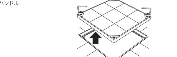
対角線上の固定ボルトに専用ハンドルを引っ掛け、上に持ち上げます。内蓋を床に置く場合は、衝撃を与えないよう、静かに置いてください。
