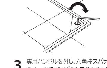
専用ハンドルを外し、六角棒スパナで内蓋4ヶ所に固定ボルトをねじ込みます。
