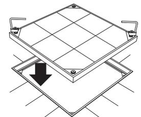
対角線上の固定ボルトを専用ハンドルに引っ掛けて、内蓋を持ち上げ、静かに外枠にはめ込みます。
