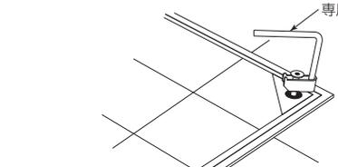
ゆるめた固定ボルトを引き出して、専用ハンドルに引っ掛けます。
