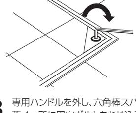
専用ハンドルを外し、六角棒スパナで内蓋4ヶ所に固定ボルトをねじ込みます。
