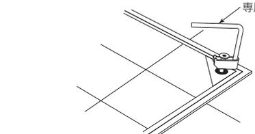
ゆるめた固定ボルトを引き出して、専用ハンドルに引っ掛けます。
