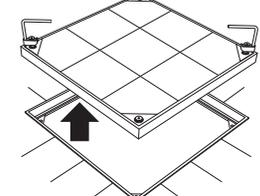
対角線上の固定ボルトに専用ハンドルを引っ掛け、上に持ち上げます。内蓋を床に置く場合は、衝撃を与えないよう、静かに置いてください。
