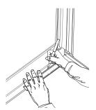
2 けがいた位置に垂れ下がり防止材を両面テープで貼り付けます。 (□303・□405は2個、□606は3個)取付位置は施工マニュアルを参照ください。
