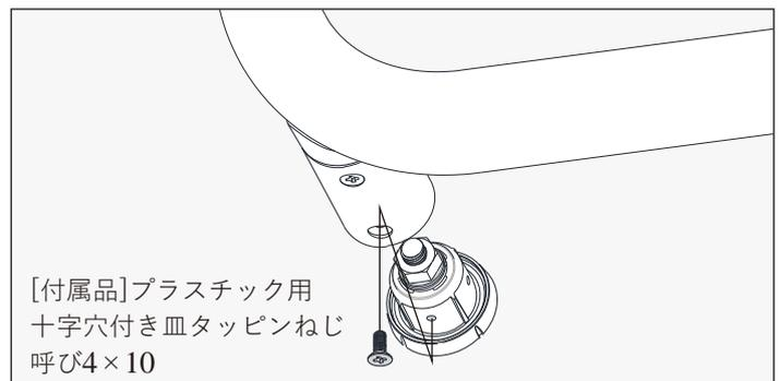
座Bに手すりを挿入し、ねじで固定します。
