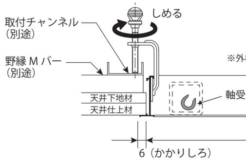
**注意** ウチワボルトはあまり強く締めると天井材が破損します。無理に力を加えないようご注意ください。
