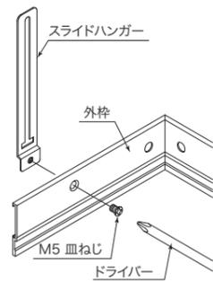
③ 外枠を天井下地材の開口に挿入します。
