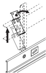
⑥ 付属の蝶ネットを取り付け、外枠のレベルを調整し、仮固定します。
