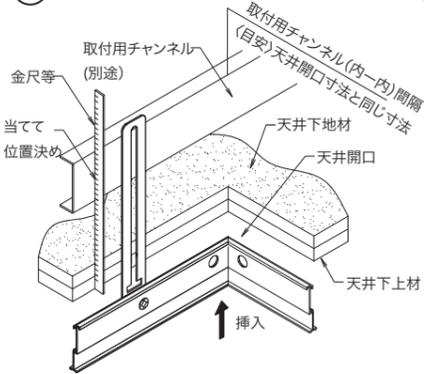
④ クランプを横にして長穴に差し込み、回転させます。
