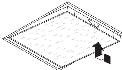
3 係止スライドをC (CLOSE) の方向へずらしてロックします。(約10mmスライドします)
