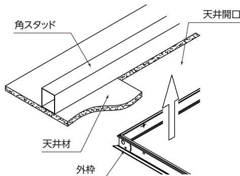
③ Zネジを外枠の穴に通し、角スタッドにねじ込んで外枠を固定してください。
