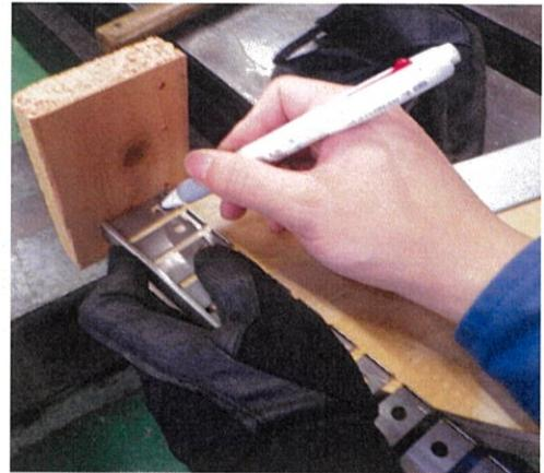
金台端部を一方の隅（壁）に押し当て、一ヶ所ビス固定位置をケガいて下さい。
