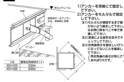
モルタルを詰める時は内蓋をはめ込み、外枠と内枠の 間に付属のスペーサーを入れて下さい
