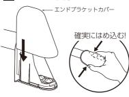
エンドブラケットの上方よ り、エンドブラケットカ バーを挿入する。エンド ブラケットカバーの両サ イドを押さえ、エンドブラ ケットに確実にはめ込む。
