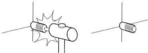
④ **4**で笠木に差込んだブラケットを移動しアンカー位置に合わせ壁に固定したアンカーに差し込む。
